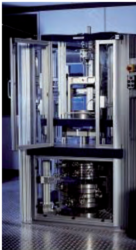
Bild 9: Kraft-Kalibrier- anlage 25 kN
