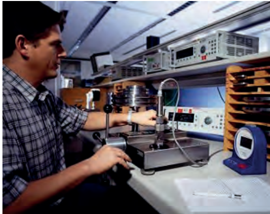
Bild 7: Kalibrierung mit einer Druck- waage
