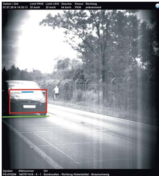
Bild 13: Van mit V_{\text{amtlich}} = 64 \text{ km/h} | V_{\text{PSS}} = 64,1 \text{ km/h} | V_{\text{PTB}} = 64,23 \text{ km/h}
