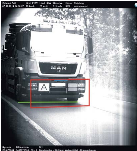
Bild 18: Lkw mit V_{\text{amtlich}} = 51 \text{ km/h} | V_{\text{PSS}} = 51,5 \text{ km/h} | V_{\text{PTB}} = 51,84 \text{ km/h}
