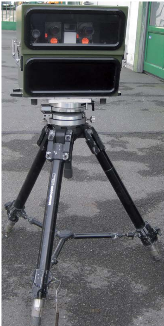
Bild 1: PoliScan-Messsystem auf Stativ montiert
