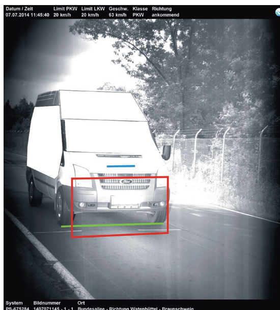
Bild 24: Kastenwagen/ Kleintransporter mit V_{\text{amtlich}} = 63 \text{ km/h} | V_{\text{PSS}} = 63,3 \text{ km/h} | V_{\text{PTB}} = 63,51 \text{ km/h}
