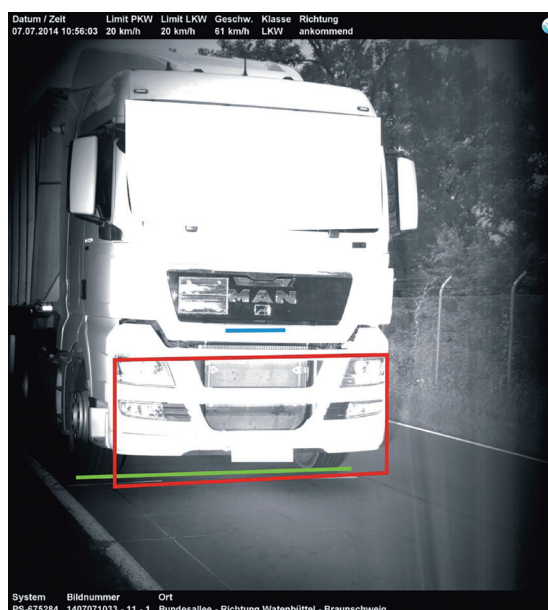
Bild 22: Lkw mit v_{\text{amtlich}} = 61\text{ km/h} \mid v_{\text{PSS}} = 61,2\text{ km/h} \mid v_{\text{PTB}} = 61,14\text{ km/h}
