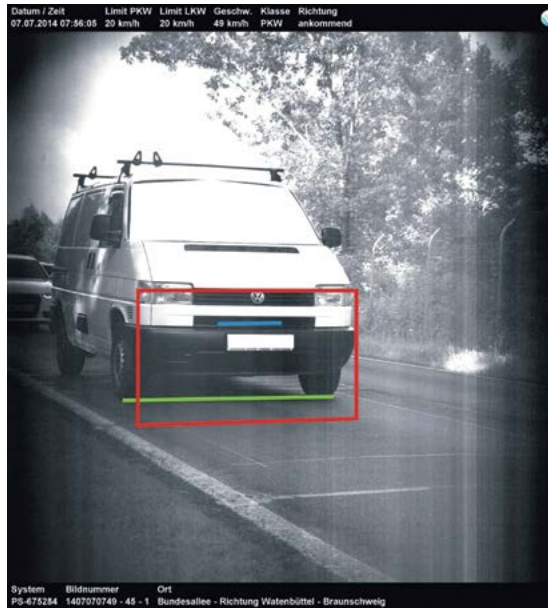
Bild 8: Kastenwagen/ Kleintransporter mit v_{\text{amtlich}} = 49\text{ km/h} \mid v_{\text{PSS}} = 49,8\text{ km/h} \mid v_{\text{PTB}} = 49,94\text{ km/h}
