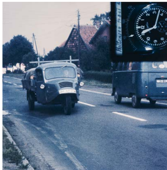
Bild 7: Beispiel für ein vom VRG 2 erstelltes Tatfoto. Über Spiegel wurden das Drehspulinstrument mit der Geschwindigkeitsanzeige, die Uhrzeit sowie die Identifikation von Messort und -datum in das Foto eingeblendet, so dass alles zusammen auf den Film gebannt wurde. Diese untrennbare Zusammenführung ist auch bei der heutigen Digitalkameratechnik eine wichtige Anforderung.
