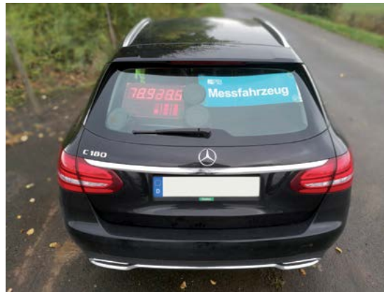
Bild 5: Einbau einer hochgenauen Uhr im Heck des PTB-Messfahrzeugs
