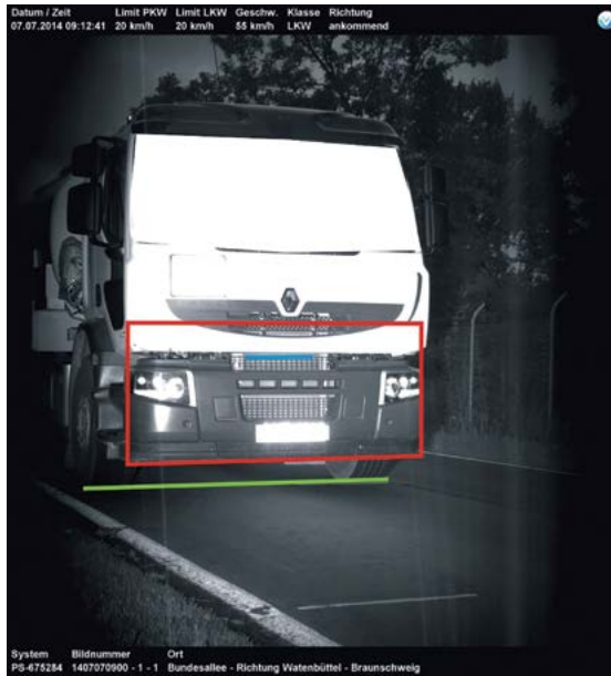
Bild 11: Lkw mit V_{\text{amtlich}} = 55 \text{ km/h} | V_{\text{PSS}} = 55,1 \text{ km/h} | V_{\text{PTB}} = 55,19 \text{ km/h}
