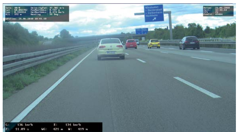
Bild 4: Stoppbild der Messung des satellitenbasierten Geschwindigkeitsmesssystems
