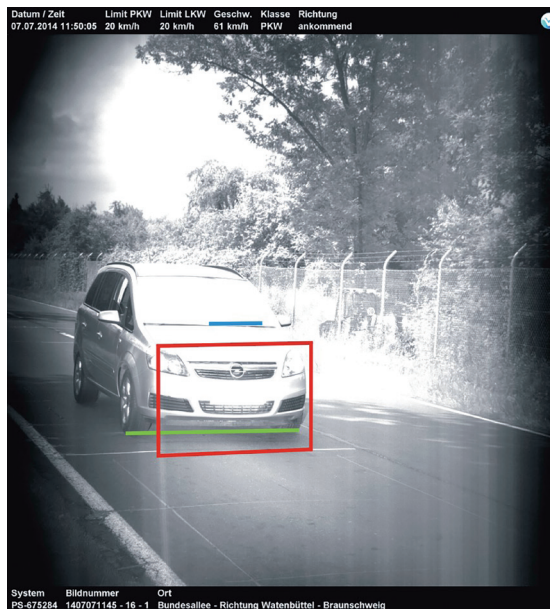
Bild 23: Van mit V_{\text{amtlich}} = 61 \text{ km/h} | V_{\text{PSS}} = 61,5 \text{ km/h} | V_{\text{PTB}} = 61,87 \text{ km/h}
