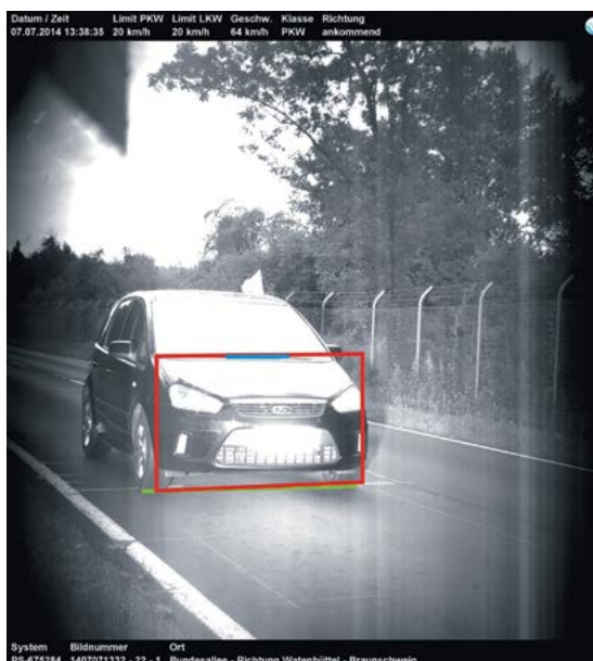
Bild 15: Van mit v_{\text{amtlich}} = 64\text{ km/h} \mid v_{\text{PSS}} = 64,4\text{ km/h} \mid v_{\text{PTB}} = 64,16\text{ km/h}
