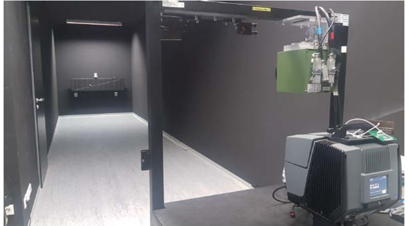
Bild 4: Prüfung eines Laserscanner-basierten Verkehrsmessgerätes auf dem Prüfstand. Die Prüfung des Messgerätes erfolgt auf einem Prüfstand und ist mittels einer speziellen Prüfsoftware teilautomatisiert. Neben Beschaffungsmerkmalen des Messgerätes wie z. B. der Version der aufgespielten Gerätesoftware werden die messtechnischen Eigenschaften des Messgerätes geprüft.
