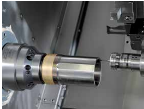
Bild 6: Antastende Messung der Testmasse zwischen den einzelnen Bearbeitungsschritten
