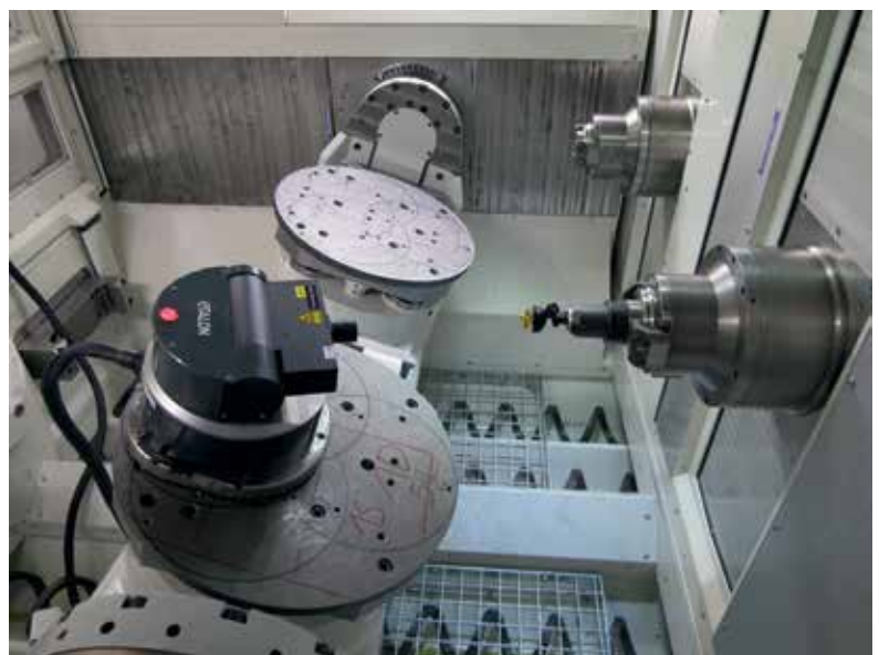
Bild 3: Geometriefehleraufnahme in der WZM mit dem LaserTracer
