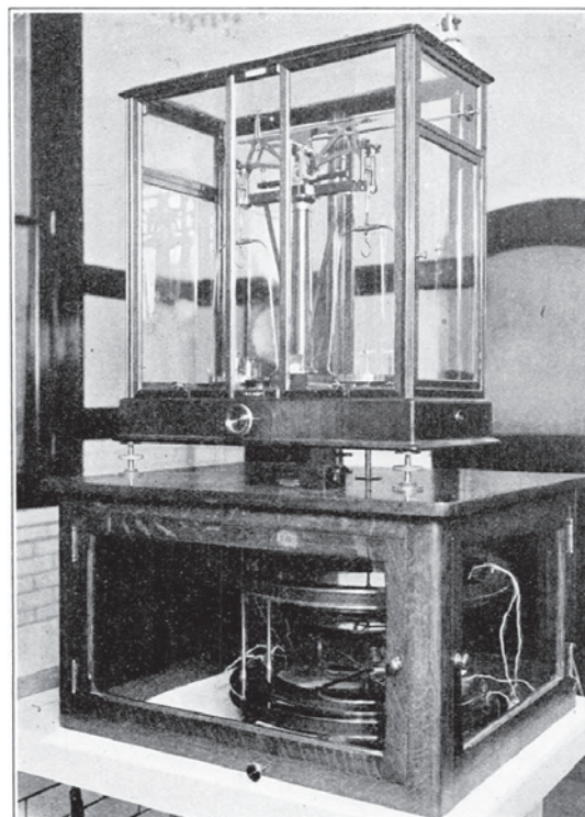
Bild 2: Stromwaage im NIST 1912. Im oberen Kasten steht eine gleicharmige Balkenwaage, im unteren Kasten befindet sich die Magnetspule, die am rechten Waagebalken hängt [4].
