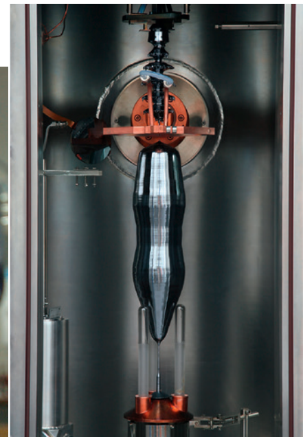
Bild 1: Oben: 4,7 kg schwerer Einkristall aus hochangereichertem 28 Si Links: Nahezu perfekte Kugeln aus 28 Si (mit jeweils einer Masse von 1 kg) Quelle Bild oben: Institut für Kristallzüchtung (IKZ)
