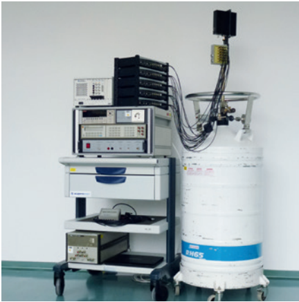
AC-Spannungsnormale bestehend aus Kryo-Einheit mit Josephson-Chip, digitaler Ansteuerung der Einzelelemente und dem Komparator, Foto: Supracon AG
