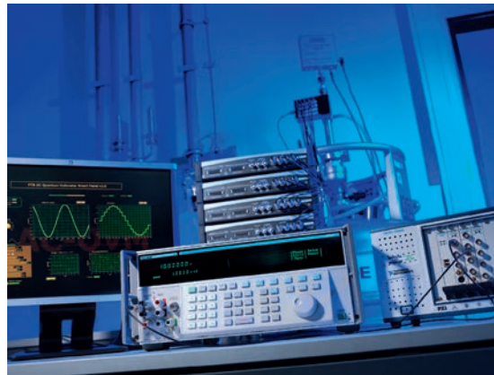
Bild 7: Ein kommerzieller Präzisions-Kalibrator (Bildmitte) wird durch den PTB-AC-Quantenvoltmeter-Laboraufbau im Wechselspannungsmodus kalibriert; Ergebnis des europäischen iMERA-plus-Projektes JOSY.
