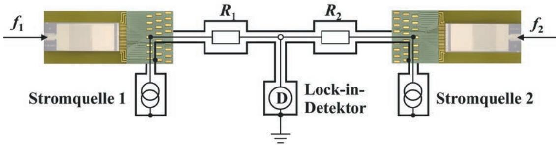
Bild 3: Schematischer Aufbau der Messbrücke auf Basis von programmierbaren Spannungsnormalen. Über die Variation der Mikrowellenfrequenzen  $f_1$  und  $f_2$  werden die quantisierten Spannungen eingestellt und die Brücke abgeglichen. Die Synchronisierung der Stromquellen 1 und 2 und Verzögerungselektronik erlaubt einen Phasenabgleich für Wechselspannungen.
