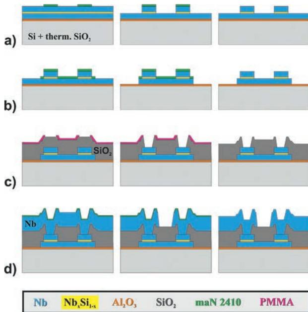
Bild 5: Schematische Darstellung des Herstellungsprozesses anhand von zwei Josephson-Kontakten: a) Definition der Josephson-Kontakte, b) Definition der Basiselektrode, c) SiO<sub>2</sub>-Isolation und Ätzen der Fenster, d) Verdrahtungsschicht. maN 2410 und PMMA sind Elektronenstrahl-empfindliche Lacke
