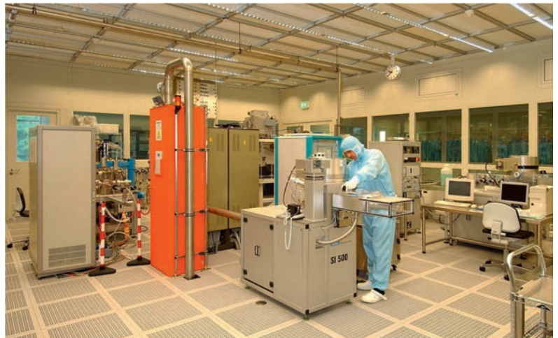
Bild 4: Blick in den Weißbereich des PTB-Reinraumzentrums, in dem u. a. Josephson-Schaltungen hergestellt werden. Spezielle Reinraumkleidung ist zur Minimierung von Verunreinigungen durch Partikel erforderlich. Verschiedene Beschichtungs- und Ätzanlagen sind Teil der Dünnschichttechnologie.
