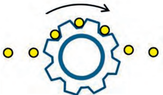
Figura 4: Ilustración del principio de la fuente de corriente de electrones individuales, representada en forma de engranaje para el transporte sincronizado de electrones individuales (cuantos de carga, representados en amarillo). Se transporta un electrón en cada cavidad entre dos “dientes” vecinos
