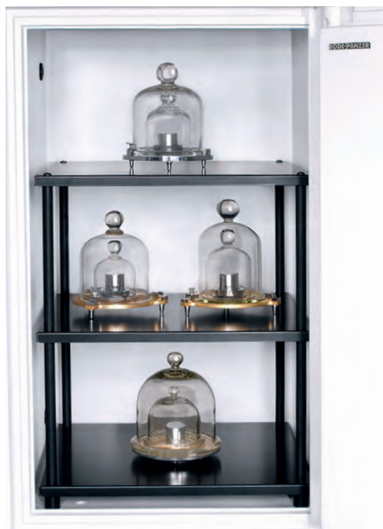
Figura 5: Guardados en forma segura: El PTB posee varios prototipos del kilogramo, como las dos piezas entregadas a principios de la década de 1950 a la República Federal de Alemania (nro. 52, estante superior de la caja fuerte) y a la República Democrática Alemana (nro. 55, estante del medio, izquierda) y el otro prototipo (nro. 70, estante del medio, derecha) comprado por la República Federal de Alemania. El patrón de kilogramo con el número 22 (estante inferior de la caja fuerte) es del año 1889, se dañó durante la guerra y ya no es un prototipo oficial.
