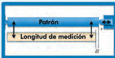
Figura 19: Principio de las mediciones mecánicas diferenciales de bloques patrón
