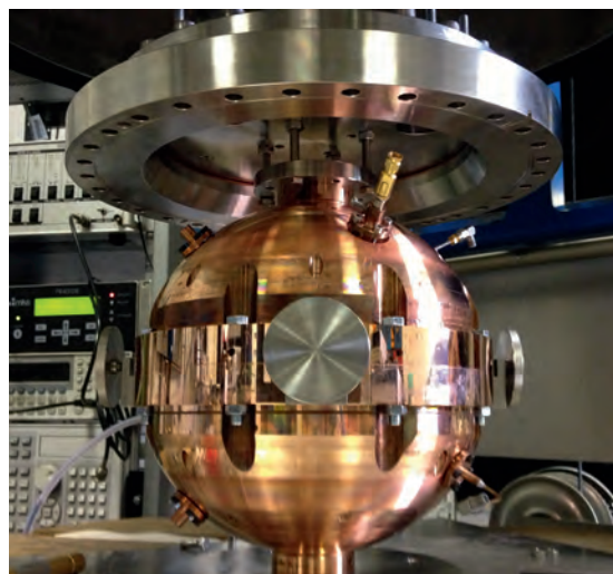
Figura 2: Termómetro acústico de gas con resonador esférico. La velocidad del sonido u_0 se determina a partir de las frecuencias de resonancia v y del diámetro d .
