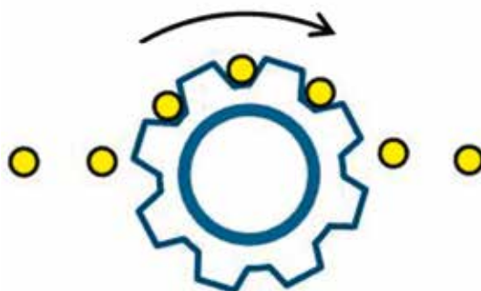
Figura 4: Ilustración del principio de la fuente de corriente de electrones individuales, representada en forma de engranaje para el transporte sincronizado de electrones individuales (cuantos de carga, representados en amarillo). Se transporta un electrón en cada cavidad entre dos “dientes” vecinos
