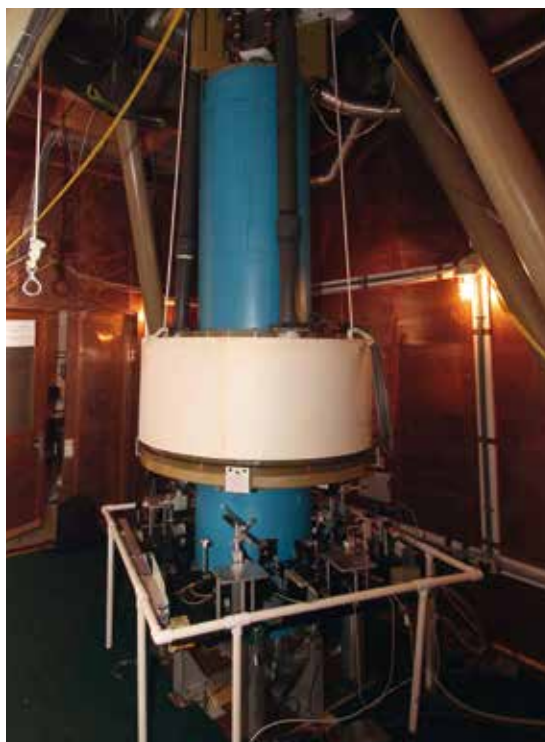
Figura 9: La balanza de Watt del NIST, parte inferior. En los cilindros azules están las bobinas superconductoras del imán, en el anillo blanco las bobinas de inducción, estas últimas en el vacío. (Foto: Autor)
