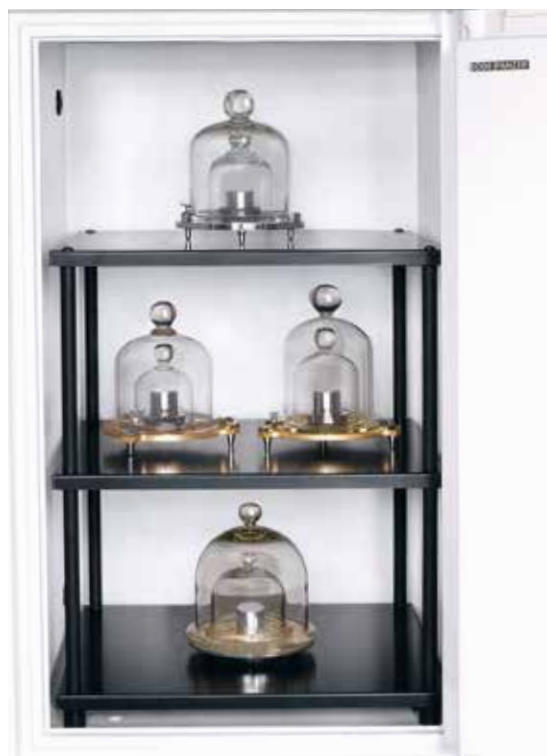
Figura 5: Guardados en forma segura: El PTB posee varios prototipos del kg, como las dos piezas entregadas a principios de la década de 1950 a la República Federal de Alemania (nro. 52, estante superior de la caja fuerte) y a la República Democrática Alemana (nro. 55, estante del medio, izquierda) y el otro prototipo (nro. 70, estante del medio, derecha) comprado por la República Federal de Alemania. El patrón de kilogramo con el número 22 (estante inferior de la caja fuerte) es del año 1889, se dañó durante la guerra y ya no es un prototipo oficial.
