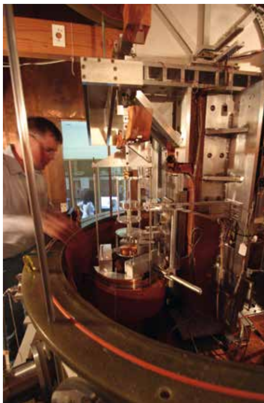
Figura 10: La balanza de Watt del NIST, nivel superior con cámara de vacío abierta, en el medio la suspensión con el dispositivo de cambio de la pesa. La polea está más arriba. (Foto: Autor)
