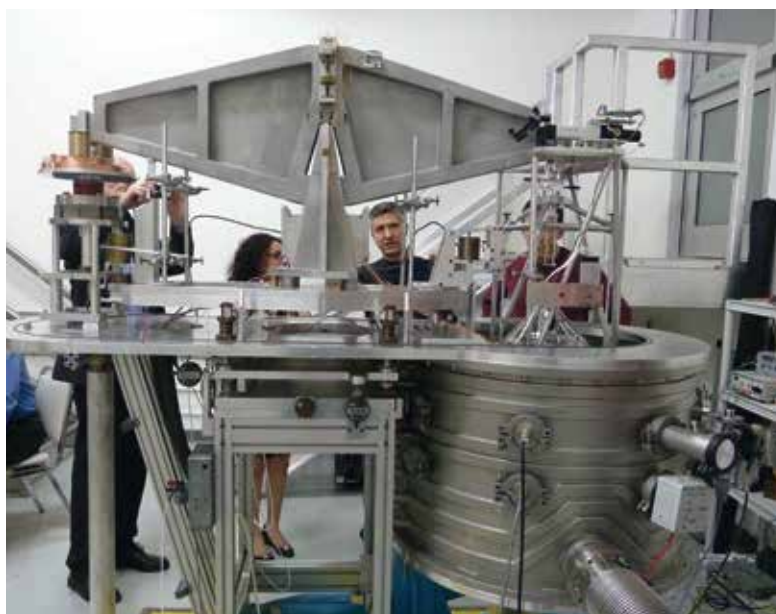
Figura 7: La balanza de Watt del NRC, se sacó la tapa de la cámara de vacío. (Foto: Autor)
