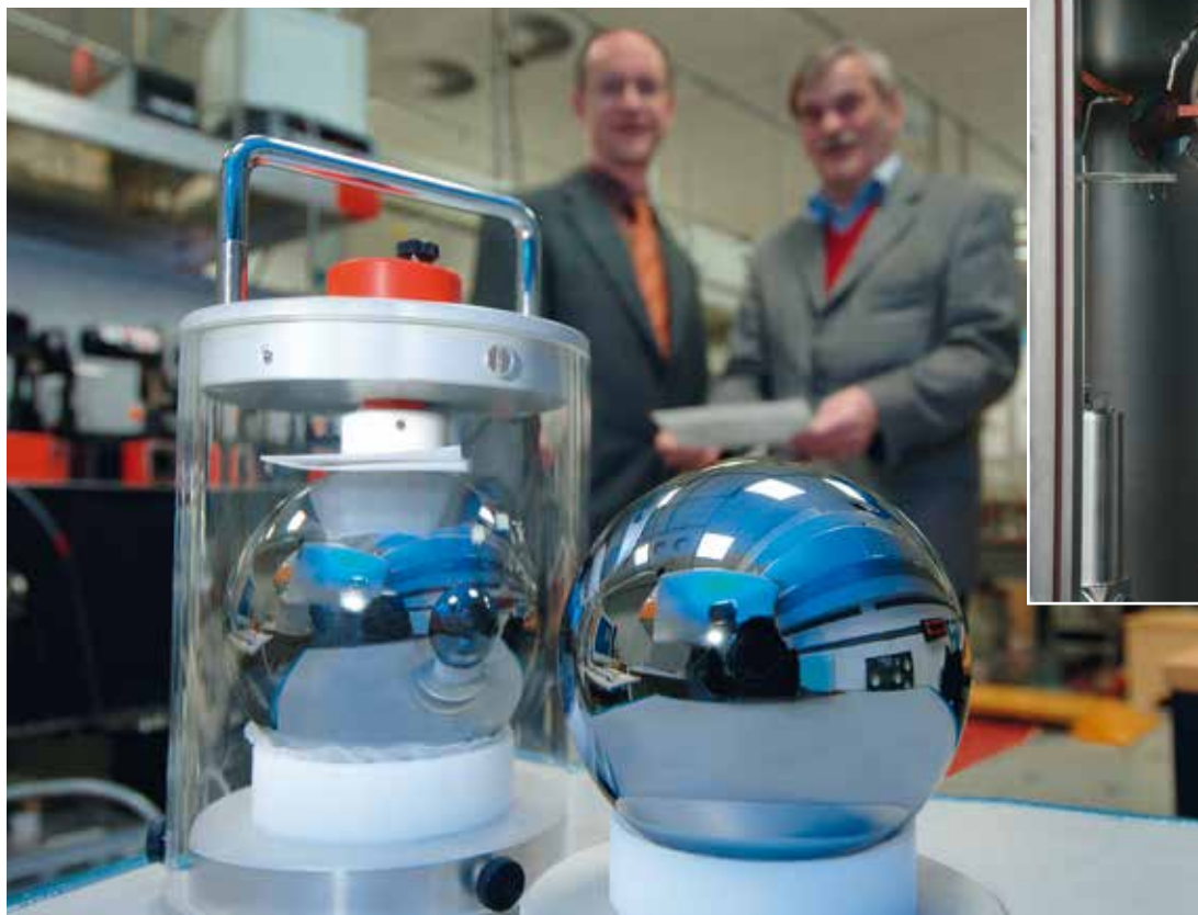
Figura 1: Arriba: monocristal de 4,7 kg de ^{28}\text{Si} altamente enriquecido Izquierda: esferas casi perfectas de ^{28}\text{Si} (cada una con una masa de 1 kg) Fuente de la figura de arriba: Institut für Kristallzüchtung (IKZ)
