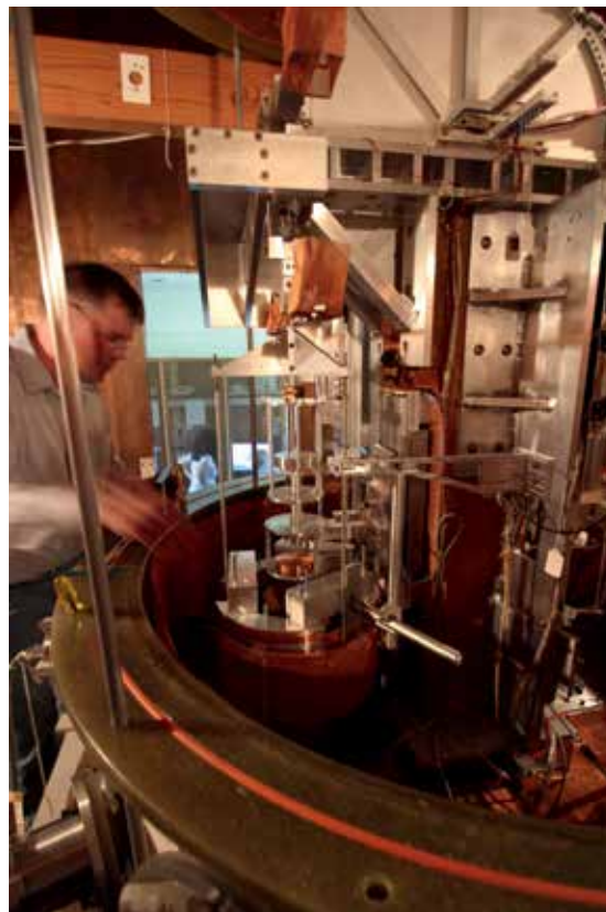
Bild 10: Die NIST-Wattwaage, obere Etage bei geöffneter Vakuumglocke, in der Mitte das Gehänge mit der Wechseleinrichtung für das Gewichtsstück. Die Seilrolle befindet sich weiter oben. (Foto: Autor)
