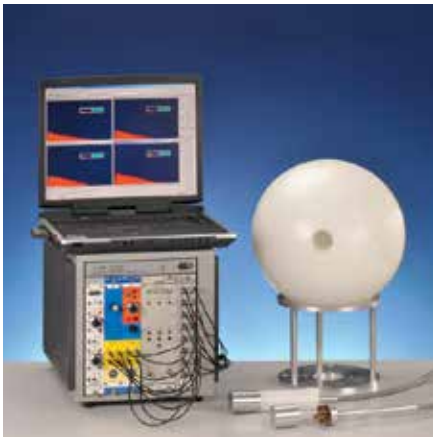
Halbleiter-Neutronenmonitor für gepulste Strahlungsfelder mit Moderatororkugel
