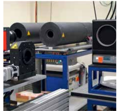
Stahlungsmessplatz der PTB zur Kalibrierung von Temperaturstrahlern und Wärmebildkameras
