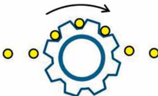
Bild 4: Illustration des Prinzips einer Einzelelektronen-Stromquelle, dargestellt als Zahnrad für den getakteten Transport einzelner Elektronen (Ladungsquanten, gelb dargestellt). In jeder Mulde zwischen zwei benachbarten „Zähnen“ wird jeweils ein Elektron befördert.
