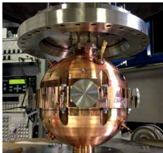
Bild 2: Akustisches Gasthermometer mit Kugelresonator. Aus den Resonanzfrequenzen \nu und dem Durchmesser d wird die Schallgeschwindigkeit u_0 abgeleitet.
