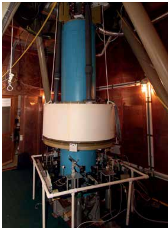
Bild 9: Die NIST-Wattwaage, untere Etage. In den blauen Zylindern befinden sich die supraleitenden Magnetspulen, im weißen Ring die Induktionsspulen, letztere im Vakuum. (Foto: Autor)
