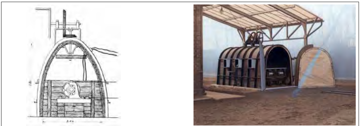
Bild 5: Schnittbild und Foto (1904) der Versuchseinrichtung für elektrische Geräte [6]
