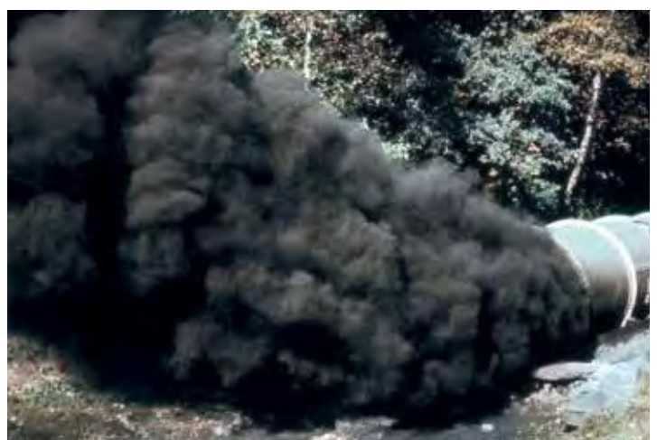
Bild 12: Fortpflanzung einer Kohlenstaubexplosion bei unterschiedlichen Kohlenstäube
