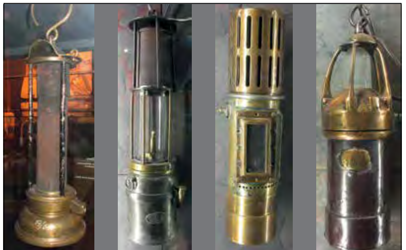
Bild 9: Schlagwettergeschützte Grubenlampen; Bauart Davy, Sicherheitslampe mit Glaszylinder, Wetterlampe, frühe elektrische Grubenlampe (von links nach rechts)
