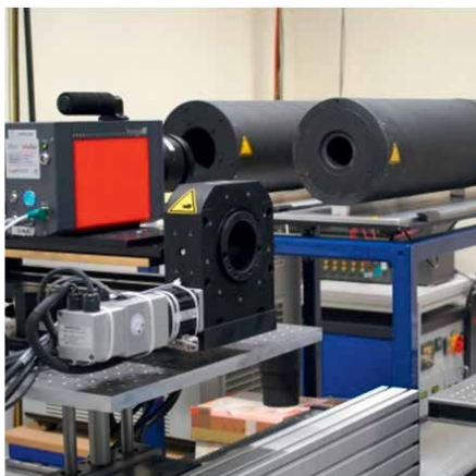
Stahlungsmessplatz der PTB zur Kalibrierung von Temperaturstrahlern und Wärmebildkameras
