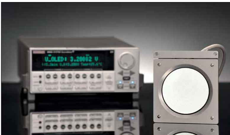
Bild 7: Temperaturgeregeltes OLED-Transfernormal auf Basis kommerziell erhältlicher OLEDs
