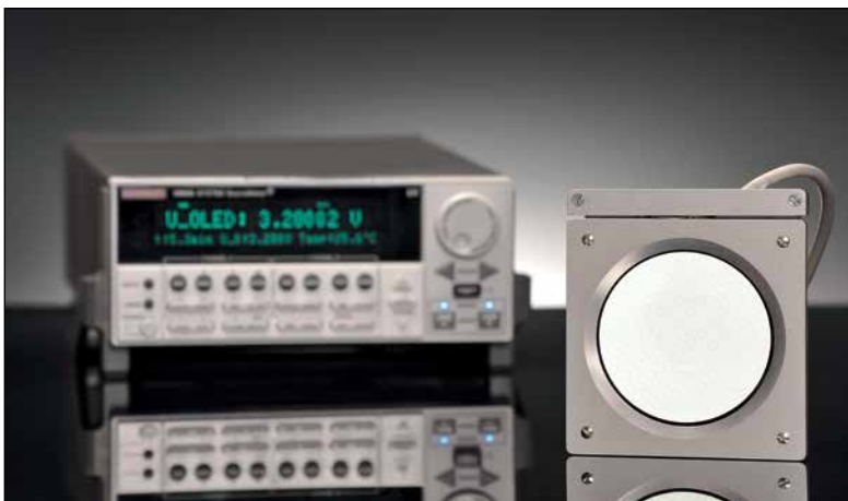
Bild 7: Temperaturgeregeltes OLED-Transfernormal auf Basis kommerziell erhältlicher OLEDs
