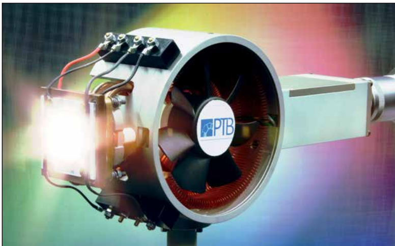
Bild 6: Temperaturgeregeltes LED-Transfernormal auf Basis von Höchstleistungs-LEDs mit Lichtströmen von bis zu 2500 Lumen
