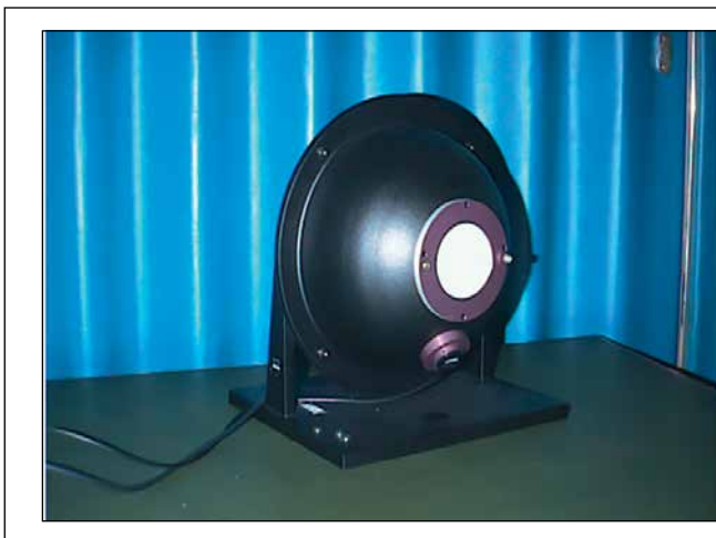
Bild 16: Glühlampenbasierte Normale zum Transfer der Leuchtdichte-Einheit
