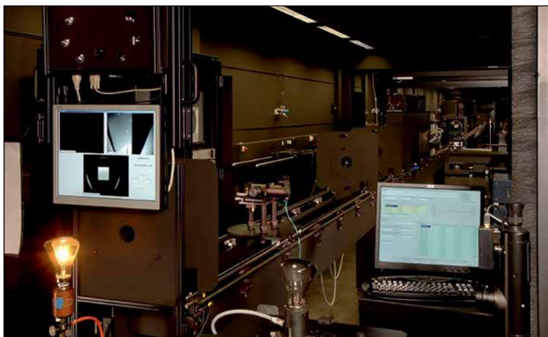
Bild 14: Die 40 m lange photometrische Bank zur Realisierung und Weitergabe der Einheit der gerichteten Photometrie
