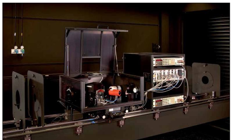
Bild 13: Messplatz zur Weitergabe der Einheit der Beleuchtungsstärke zur Kalibrierung von Photometern
