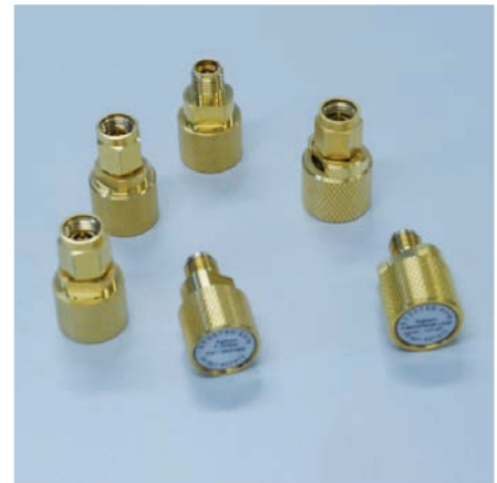
Koaxiale Kalibrierstandards zur Kalibrierung vektorieller Netzwerkanalysatoren
