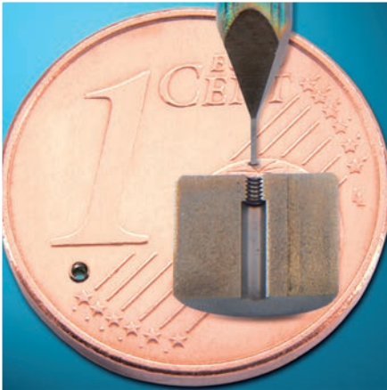
Mikrohanteltasterstift mit Tastkugeldurchmessern von 110 µm bei der Messung eines Mikro-Innengewindes mit der Bezeichnung M 0,7 × 0,175
