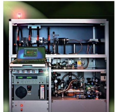
^{129}\text{Xe} -Polarisator der PTB, in den das Gas-trennmodul als Subkomponente integriert wird
