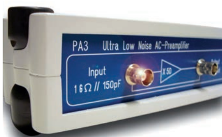
oben: geringstmögliches Rauschen durch selektierte Feldeffekttransistoren unten: Prototyp des Verstärkers
