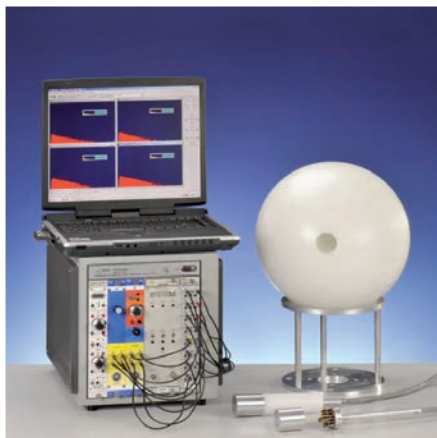
Halbleiter-Neutronenmonitor für gepulste Strahlenfelder mit Moderatorerkugel
