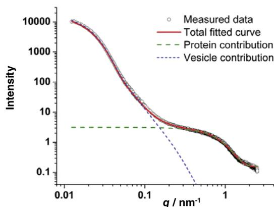
Bild 8: Streukurve für Erythrozytvesikel, die sich durch eine Vesikelverteilung mit einem mittleren Durchmesser von 125 nm und einer Halbwertsbreite der Größenverteilung von 90 nm sowie einen Beitrag von deutlich kleineren freien Proteinen beschreiben lässt.
