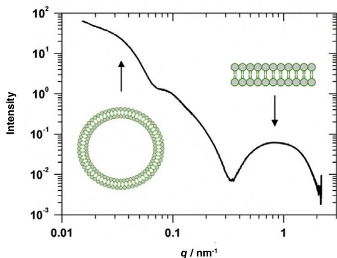
Bild 7: Streukurve für Phospholipid-Vesikel, aus deren Verlauf sich bei kleinen  $q$ -Werten ein mittlerer Durchmesser von 75 nm und bei großen  $q$ -Werten eine Dicke der Doppelschicht von 4 nm bestimmen lässt [13].
