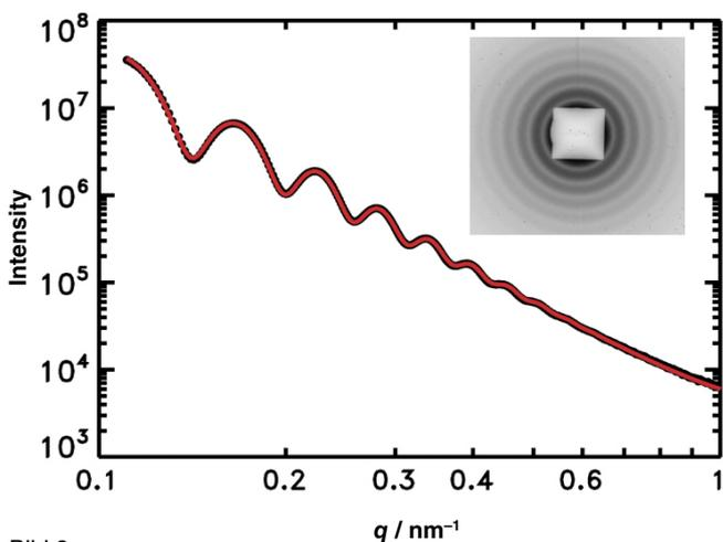
Bild 3: Streukurve für nahezu monodisperse PMMA-Partikel mit einem nominellen Durchmesser von 108 nm. Der Fit ergibt einen mittleren Durchmesser von (109,0 ± 0,8) nm.
