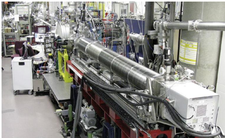
Bild 2: SAXS-Instrument des HZB am FCM(Four-Crystal-Monochromator)-Strahlrohr im PTB-Labor bei BESSY II. Rechts unten ist der direkt verbundene, vakuumkompatible PILATUS-Detektor zu erkennen.
