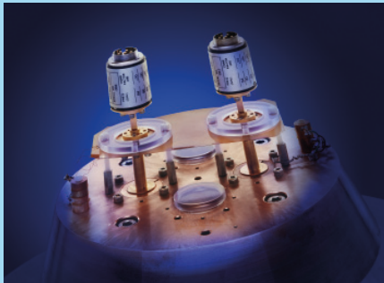
Kalorimeter zur Kalibrierung von HF-Leistungsthermistoren
