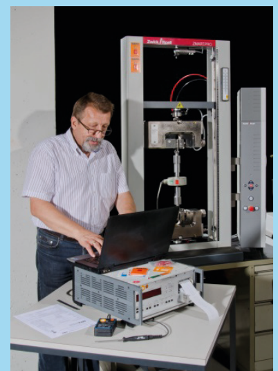
Kalibrierung einer Werkstoffprüfmaschine
