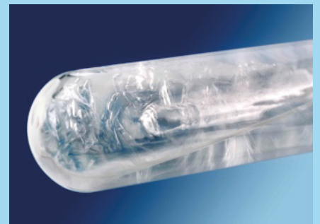
Ячейка реперной точки воды
