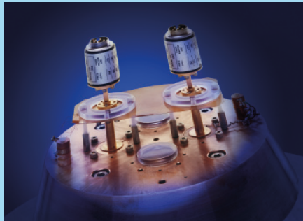
Калориметр для калибровки мощных высокочастотных термисторов
