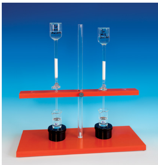
Bild 3: Trennsäule für die Abtrennung des Sr von störenden Radionukliden und die Trennung von Sr- und Y-Isotopen vor der Herstellung der Messpräparate.
