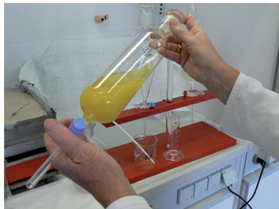
Bild 6: Flüssig-Flüssig-Extraktion von Plutonium aus einer Luftstaubprobe.
