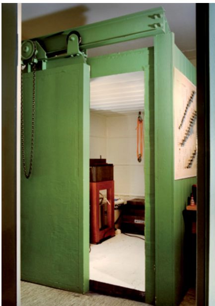
Bild 3: Die bis 1997 von der Spurenmessstelle genutzte Bleikammer aus Blei mit geringer Eigenaktivität.
