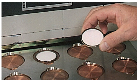
Bild 4: Beispiel eines Messpräparates zur Aktivitätsbestimmung von Y-90 oder von Sr-89 und Sr-90 zum Einsatz im Proportionalzählrohr.
