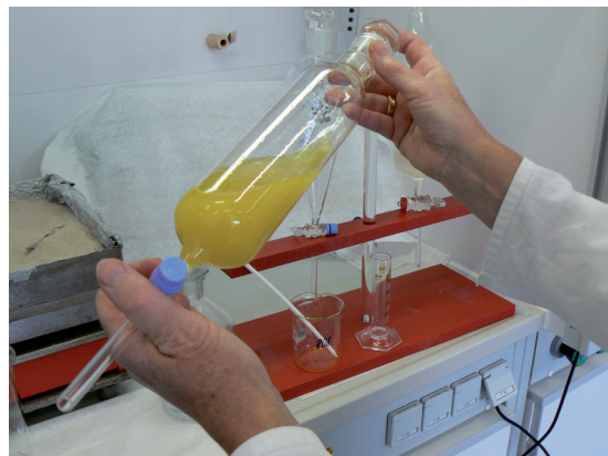
Bild 6: Flüssig-Flüssig-Extraktion von Plutonium aus einer Luftstaubprobe.
