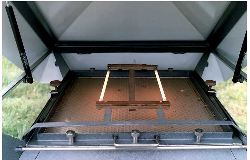
Bild 4: Blick auf den Filter des Luftstaubsammlers bei geöffnetem Deckel.
