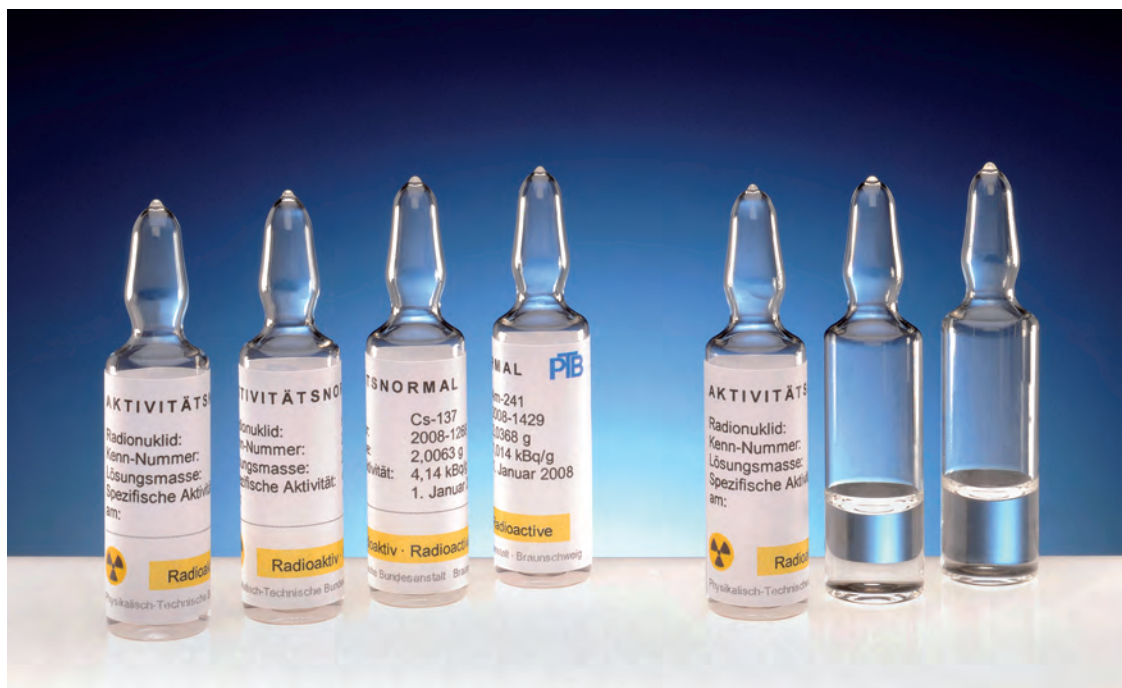
Abbildung 1: Aktivitätsnormale der PTB werden u. a. als wässrige Lösung in abgeschmolzenen Glasampullen hergestellt und angeboten.
