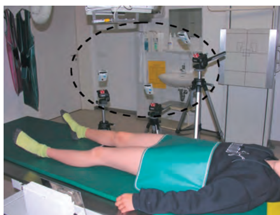
Bild 4: Messungen mit elektronischen Personendosimetern auf Stativen an potentiellen Aufenthaltsorten helfender Personen.
