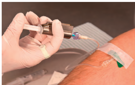
Bild 1: Nuklearmedizinische Untersuchung. Das weiße Fingerring-Dosimeter wird am Zeigefinger mit dem Detektor zur Spritze getragen.
