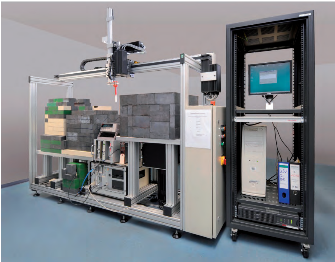
Abbildung 2: Messplatz der PTB mit zwei Ionisationskammern und automatischem Probenwechsler.
