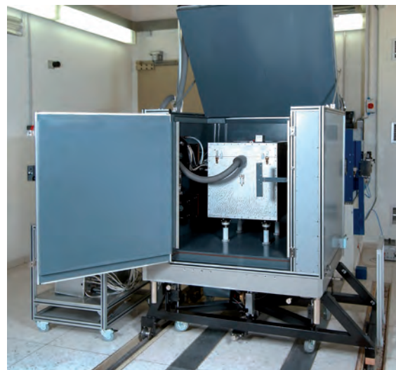
Abbildung 1a: Foto des Außengehäuses von der Rückseite mit geöffnetem Deckel und geöffneter Tür. Mittig im Außengehäuse montiert befindet sich das eigentliche Kalorimeter, bestehend aus Wasserphantom (inkl. Wärmedämmung) und eingebautem Detektor.
