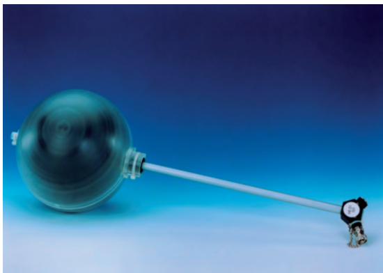
Bild 1: Photo der Sekundärnormal-Ionisationskammer für die Messgröße Umgebungs-Äquivalentdosis H^*(10)
