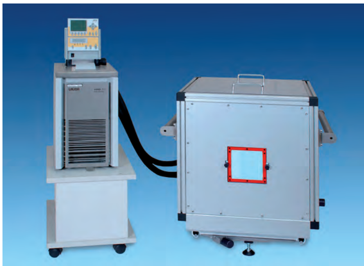
Abbildung 3: Das sogenannte „transportable“ Wasserkalorimeter mit zugehörigem Kühler. Die Temperaturstabilisierung dieses Kalorimeters geschieht mit Hilfe aktiv gekühlter Platten, die das gesamte Wasserphantom bis auf den Bereich des Strahlungseintrittsfensters (rot umrandet) umgeben. Die Kantenlänge des Kalorimeters beträgt ca. 60 cm. Die Dicke der Dämmschicht aus Polystyrol beträgt im Bereich des Strahlungseintrittsfensters ca. 18 cm.
