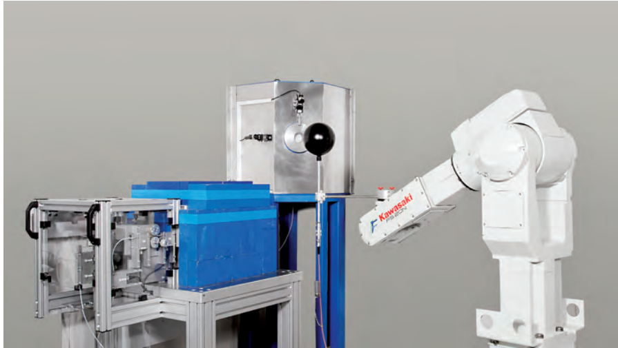
Abb. 1: Messanordnung zur Kalibrierung von HDR-Brachytherapiequellen in kollimierter Strahlungsgeometrie. Afterloader (links), Kugel-Ionisationskammer (Mitte), Bleikammer (Mitte, hinten), Industrieroboter (rechts).
