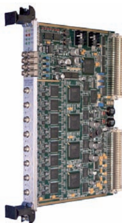
Bild 3: Zur Phasenmessung genutzter 100 MHz 16 Bit Analog-Digital-Wandler und Stabilität der Phasenmessung über 50 Stunden
