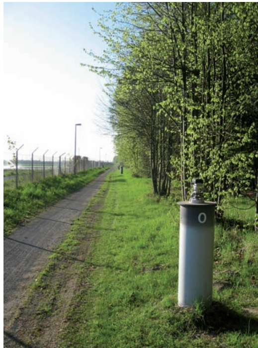
Bild 4: 600-m-Pfeilerstrecke am Nordgelände der PTB.
