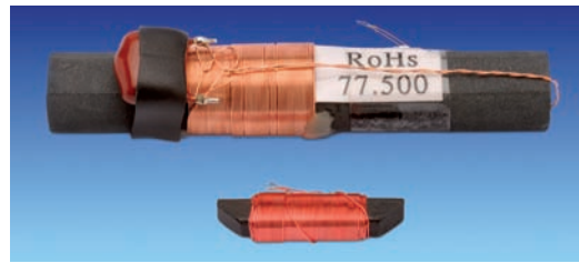
Bild 7: Oben: Ferritantenne für Großuhren, 10 mm x 60 mm. Unten: Ferritantenne für Armbanduhren, 3,5 mm x 17 mm. Die kleine Antenne für Armbanduhren wird erst bei Anschluss an die Leiterplatte zu einer funktionsfähigen Antenne, da sich dort der zugehörige Schwingkreiskondensator befindet. Der Ferritstab ist an den Enden angeschrägt, um sich besser ins Gehäuse einzupassen.
