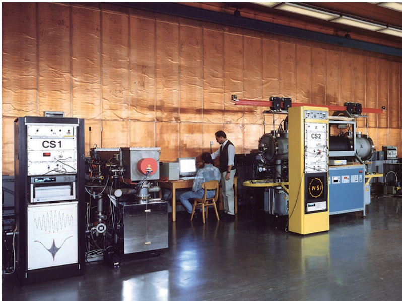
Bild 3: Ansicht der primären Uhren CS1 und CS2 der PTB.
