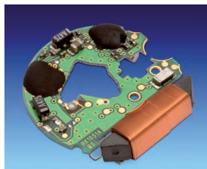
Bild 2: Elektronikleiterplatte mit angelöteter Antenne.
