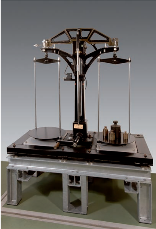
Bild 5: Wägeeinrichtung des Pipetten-Prüfstandes für die Darstellung kleiner statischer Volumina bis 100 Liter
