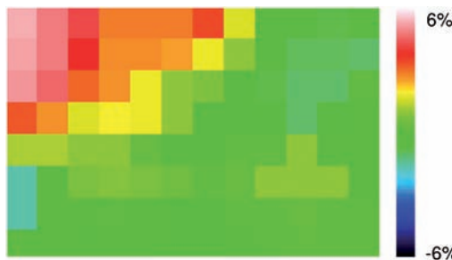
Bild 10: Aus Bild 9 mittels Medianfilter (3x3) errechnete relative systematische Abweichungen in Falschfarbendarstellung
