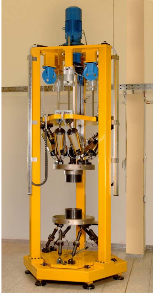
Bild 2: Mehrkomponenten-Referenzmesseinrichtung mit einem Kraftvektorbetrag von maximal 10 kN und einem Momentvektorbetrag von maximal 1 kN·m.
