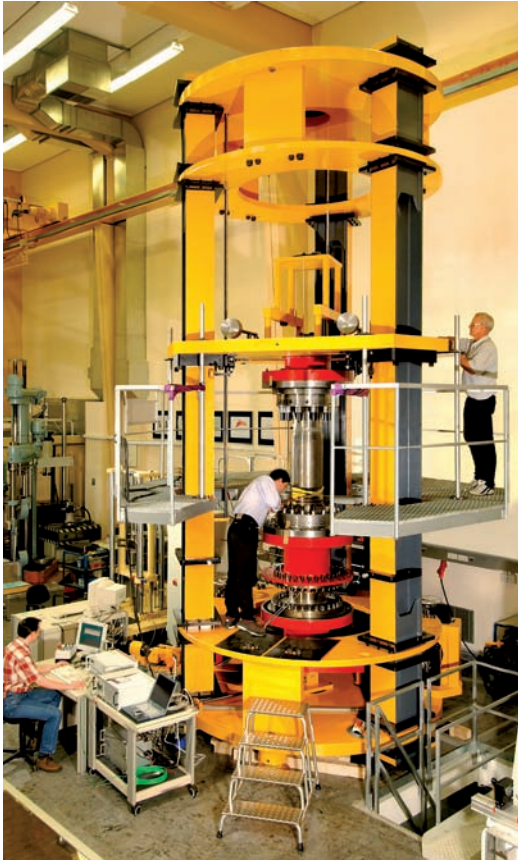
Bild 4: 1,1-MN·m-Drehmoment- Normalmesseinrichtung mit Messbereichen von 4 kN·m bis 220 kN·m sowie von 20 kN·m bis 1,1 MN·m
