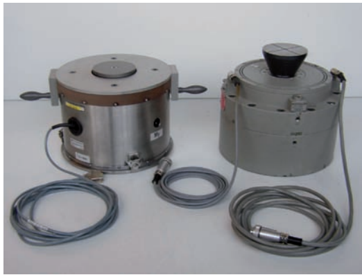
Bild 2: 1-MN-Kraftaufnehmer, die bei dem 1-MN key comparison verwendet werden.
