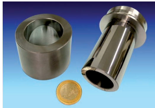
Bild 3. Kolben-Zylinder-System mit der nominellen Querschnittsfläche 10 cm 2 zur primären Darstellung der Druckskala in Gasen im Bereich von 50 kPa bis 1 MPa.
