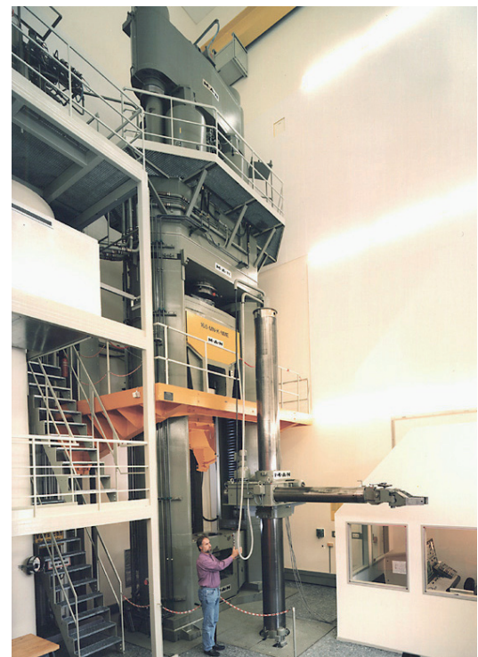
Bild 7: 16,5-MN-K-NME mit hydraulischer Übersetzung
