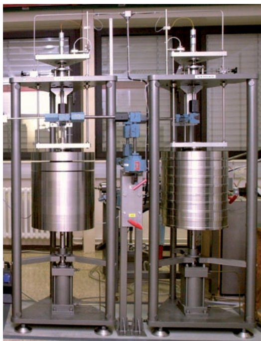
Bild 4. Normal-Kolbenmanometer zur Darstellung der Druckskala in Flüssigkeiten im Bereich von 0,5 MPa bis 1 GPa.
