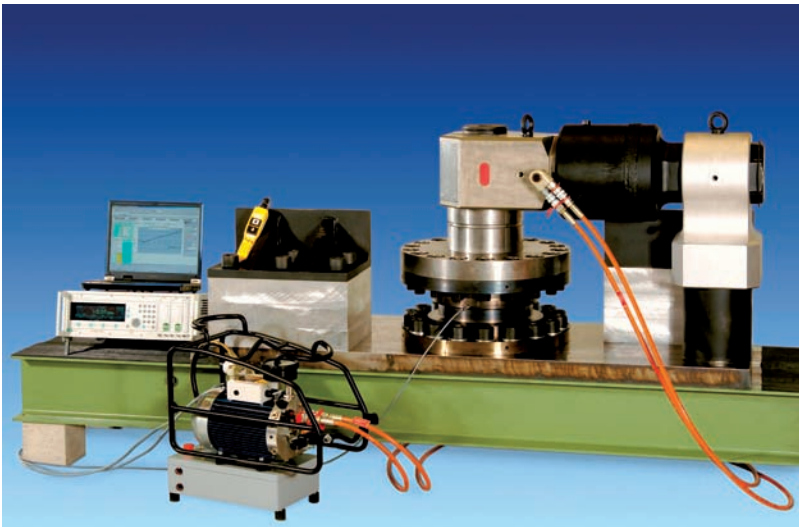
Bild 5: Hydraulischer Kraft- schrauber bis 70 kN·m in einer Kalibriereinrichtung
