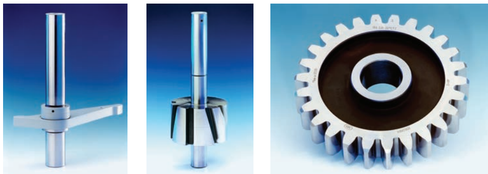
Bild 2: Klassische Verzahnungsnormale (v.l.n.r.): Profil, Flankenlinie und Teilung
