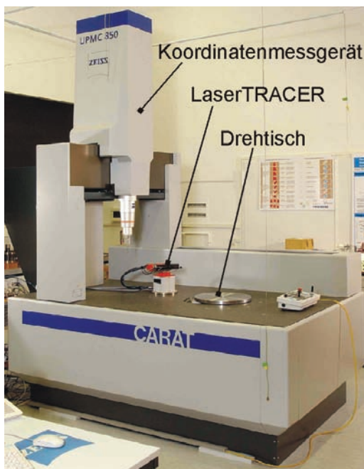
Bild 7: Komponenten der Normal-Messeinrichtung für die Verzahnung
