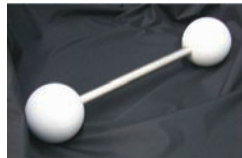
Bild 7: Prüfkörper für optische Abstandssensoren mit matten Oberflächen. Links [15], Mitte: Kugelstab/Kugelleiste zur Bestimmung von Antast- und Längenmessabweichung, rechts: Ebenheitsnormal zur Bestimmung der Ebenheitsabweichung [15]
