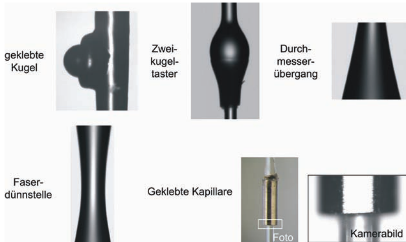
Bild 5: Erprobte Ausführungen der Zielmarke für den taktil-optischen 3D-Taster (Durchmesser der Faser im Bereich des Taster- schaftes: 250 \mu\text{m} )
