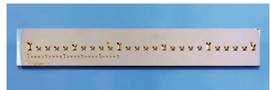
Bild 9: Längenmaßstab aus Silicium als Maßteilung für das Konturen- TransfERNormal. Tiefe der Strukturen ca. 0,9 mm, Beschichtung mit Titanitrit, Neigung des Maßstabes mit einem Sinustisch.
