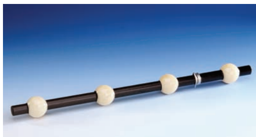
Bild 9: Kalibrierter Kugelstab (4 Keramikugeln Ø30 mm auf Kohlefasersstab, Kugelabstand 100 mm) zur Bestimmung und Korrektur von Maßstabsfaktoren
