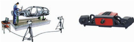
Bild 5: Optische 3D-Messsysteme für die Messung großer Teile. links: Photogrammetrische Anordnung [14], rechts: Mobiles Streifenprojektions-Messgerät [15]
