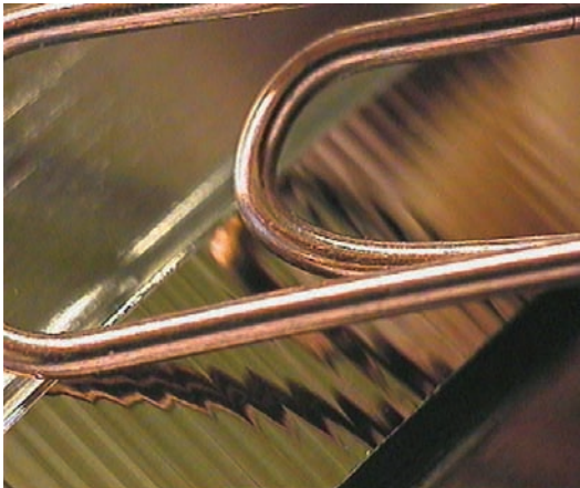
Bild 4: Wellen auf einem Mehrwellennormal im Vergleich zu einer Büroklammer
