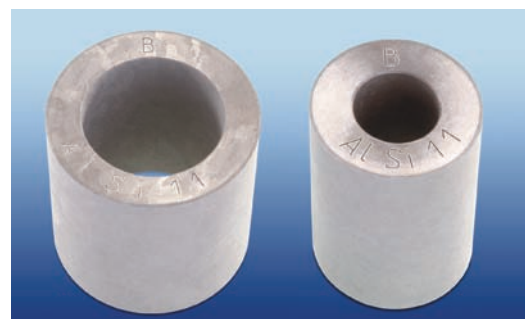
Bild 10: Aluminium-Hohlzylinder mit kalibrierten Außen- und Innendurchmessern (links: Ø30 mm/20 mm, rechts: Ø20 mm/10 mm) zur Schwellwertbestimmung
