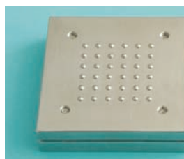
Bild 8: Prüfkörper zur Bestimmung der Längenmessabweichung von Messsystemen für kleine Merkmale. Links: Kugelplatten mit 2 mm bzw. 0,5 mm Kugeldurchmesser, rechts: Kugelkalottenwürfel mit 0,8 mm Kalottendurchmesser
