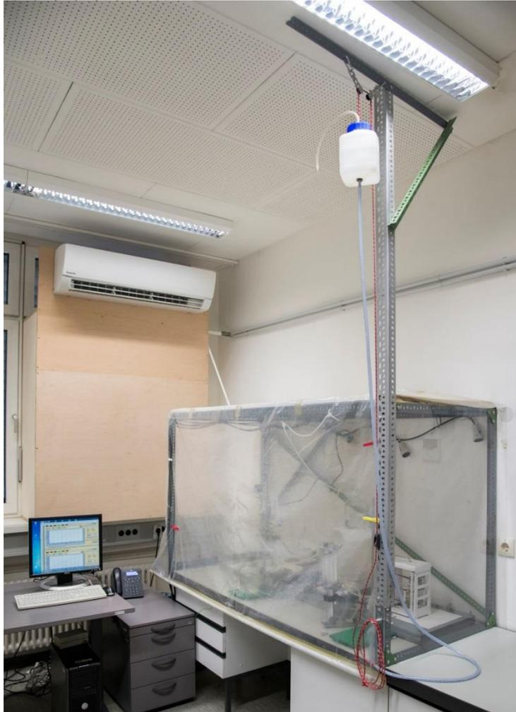
Abbildung 3: Gesamtansicht der im klimatisierten Laborraum in der zusätzlichen Klimaeinhausung befindlichen Prüfapparatur gemäß UN Test N.5 sowie der Verifizierungsapparatur und dem zur Generierung eines konstanten Wasservordrucks unter der Raumdecke (rechts oben im Bild) aufgehängten Wasservorratsbehälter, der per Schlauch mit dem Rotameter verbunden ist (Quelle, Foto: BAM)
