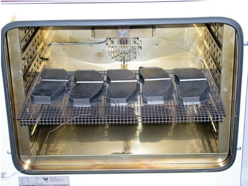
Abbildung 12: Bremsbeläge zur Härtung
