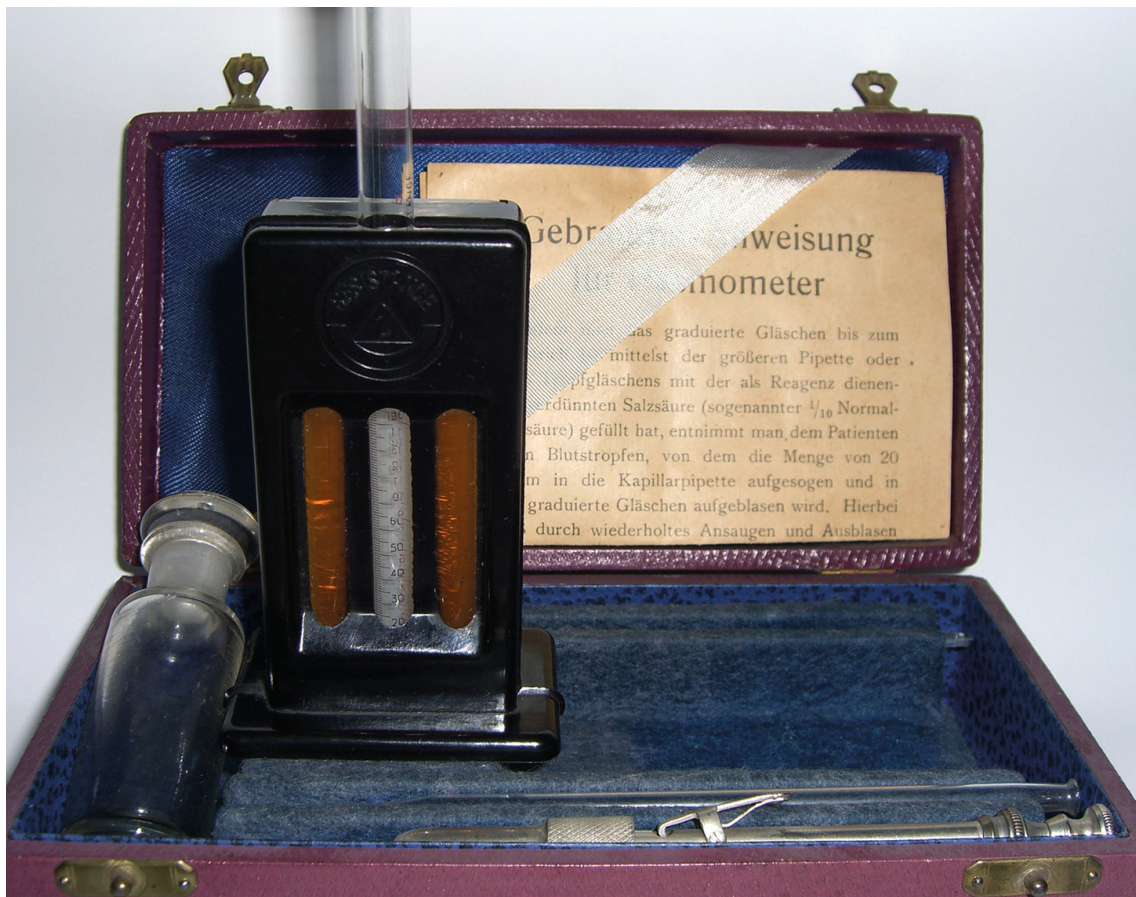
Abbildung 2: Hämoglobin-Messgerät nach dem Prinzip von Sahli der Fa. ERKA, ca. 1930: „geeicht von der GIM-Prüfungsstelle“. [Quelle: https://de.m.wikipedia.org/wiki/Datei:Sahli-Hämometer.JPG ; 26. Mai 2007, Urheber: Eberhard J. Wormer; GNU-Lizenz für freie Dokumentation, Version 1.2]
