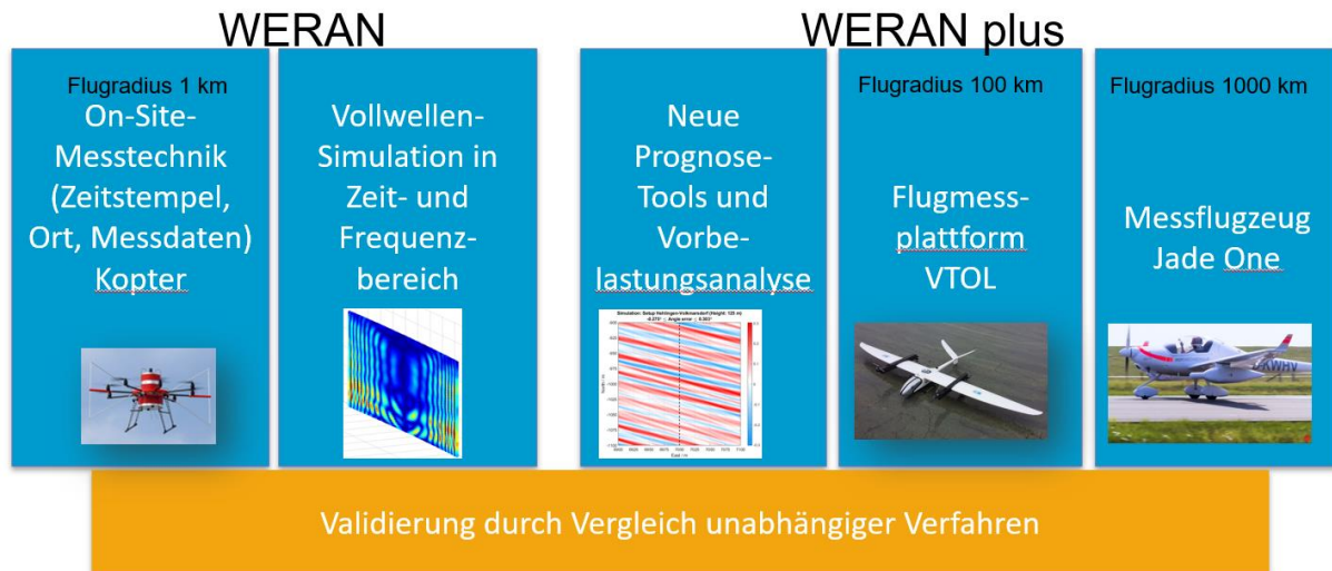
Abbildung 2: Übersicht von Messmöglichkeiten und Simulationstechnologien aus den Projekten WERAN und WERAN plus.
