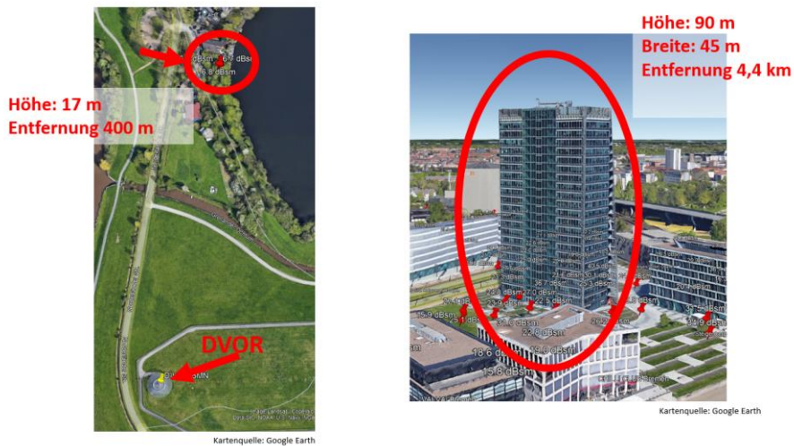
Abbildung 14: Details aus der Clutter-Map. Die linke Grafik zeigt einen als Hindernis detektierten Baum in 400 m Abstand und mit 17 m Höhe, die rechte Grafik zeigt ein größeres Gebäude in 4,4 km Entfernung.
