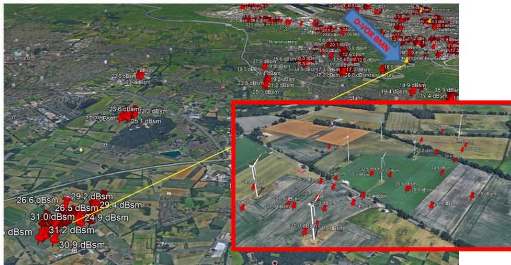
Abbildung 15: Windpark ca. 8,5 km südwestlich vom DVOR Bremen als Teil der Cluttermap.
