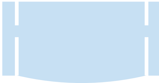
Abbildung 3.4: Schnittdarstellung der Kollimationslinse. Die Schnittebene beinhaltet die optische Achse der Linse.
