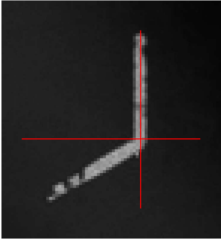
Abbildung 4.12: Ausschnitt des am Arm 1 aufgenommenen Interferogramms zur Kugeljustage um die Kugelmarkierung nach Positionierung der Kugel. Die roten Linien markieren den Mittelpunkt der Markierung und die Position der Pixel (255,255), die nach der Kugelpositionierung identisch sind.
