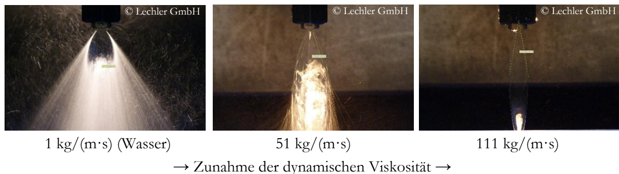
Abbildung 2.3: Sprühbilder der Flachstrahldüse 652 der Firma Lechler in Abhängigkeit der dynamischen Viskosität bei einem Pumpendruck von 2,0 bar 5
