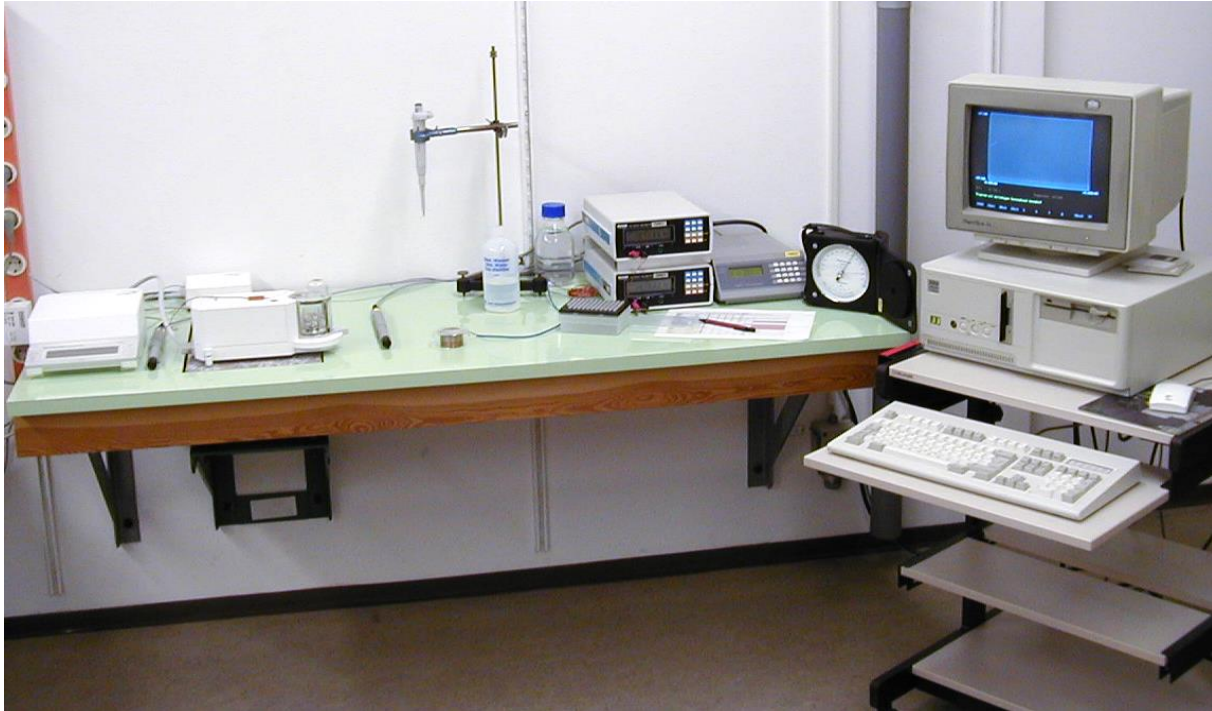
Abb. 2: Fotografie der Messapparatur Links die Waage, bestehend aus Wägeteil, Steuerteil und Netzteil. Auf der freien Fläche in der Mitte des Tisches befindet sich das Vorratsgefäß für die Flüssigkeit, darüber im Stativ das Dosiergerät. Rechts die Digitalohmmeter für die Messung der Thermometerwiderstände und Messgeräte für Luftdruck und Luftfeuchte. Neben dem Messtisch befindet sich ein PC zur Datenerfassung.
