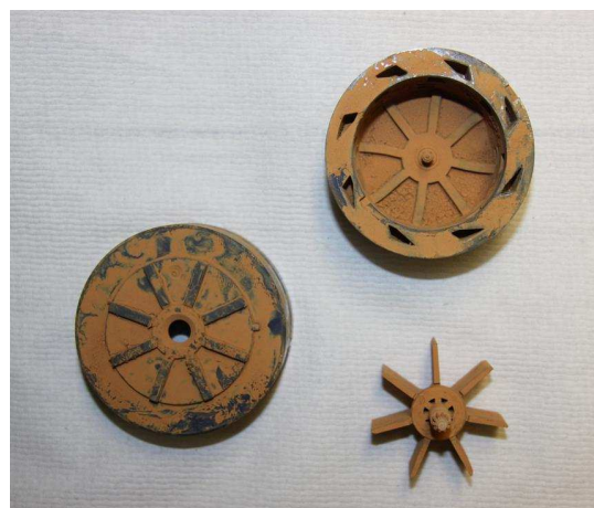
Bild 7: Einzelteile des verschmutzten Zählers B
