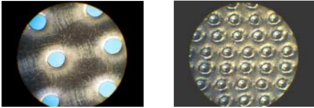
Abbildung 7-2: Festkörper-Tantal-Targets nach Beschuss mit hochintensiven Laserpulsen (Lichtintensität ca. 10^{19} W/cm 2 ). Durchmesser des Ausschnitts: ca. 1,4 mm. Links: Dünnes Target (12 \mu m dick): Durch den Einschuss entstehen Löcher von ca. 200 \mu m im Durchmesser. Rechts: Dickes Target (1 mm dick): Die entstehenden Krater sind ca. 100 \mu m im Durchmesser und einige zehn Mikrometer tief.
