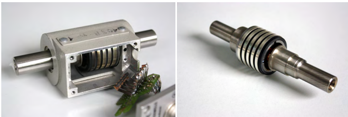
Abbildung 5.5: Geöffneter HBM T5 Aufnehmer mit Schleifkontakten (links) und Messwelle (rechts).
