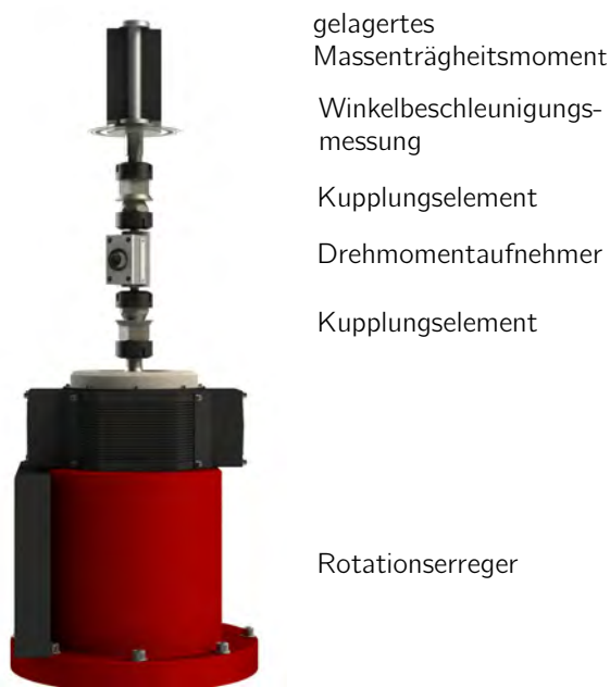
Abbildung 3.2: Schematischer Aufbau einer dynamischen Drehmomentmesseinrichtung.
