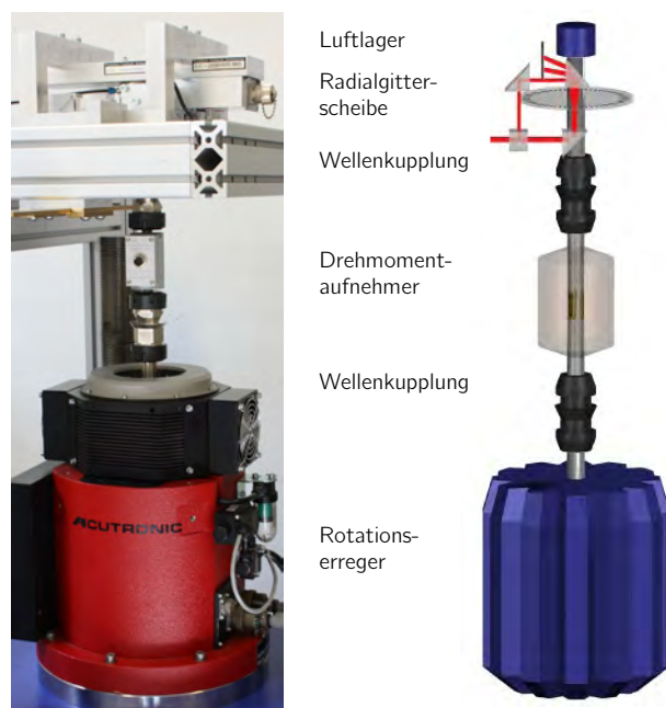
Abbildung 4.2: Komponenten der dynamischen Drehmomentmesseinrichtung.
