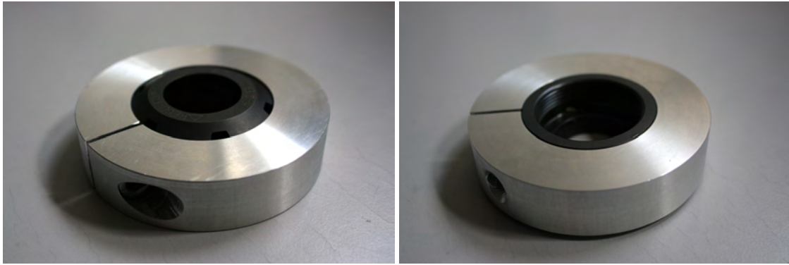
Abbildung 5.8: Ringförmiger Massekörper mit ER-32-Spannmutter.
