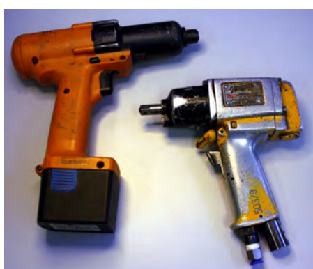
Abbildung 1.1: Impulsschrauber des Herstellers Uryu mit pneumatischem bzw. elektrischem Antrieb (links), Drehmomentverlauf eines Anziehvorgangs (rechts).
